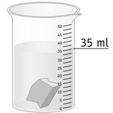
**34** Calcola il volume di un corpo solido di forma irregolare immergendolo in un cilindro graduato riempito d'acqua come nella figura.
